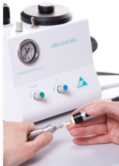
↳ Bearbeitung eines Zirkonabutments mit der Laborturbine LED Carver
