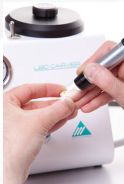
↳ Bearbeitung einer Zirkonkrone mit der Laborturbine LED Carver
